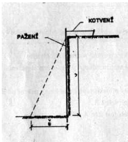
Objem výkopu v zapaženém prostoru se rovná  $0,25 \times d \times v^2$
